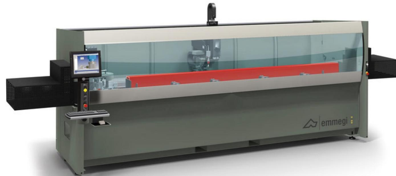
Centro di lavoro CNC a 4 assi controllati, dedicato alla lavorazione di barre o pezzi in alluminio, PVC, leghe leggere in genere e acciaio sino a 2 mm. Gruppi morsa a posizionamento automatico. Dispone di magazzino utensili a 4 posti o a 8 posti (opzionale), con possibilità di ospitare 2 unità angolari e una fresa a disco, per eseguire lavorazioni su 5 facce del pezzo. Lavora barre sino a 4 m di lunghezza.
