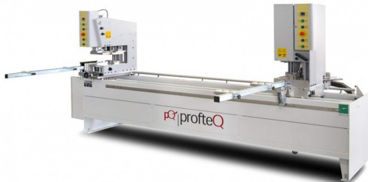
Saldatrice automatica a 2 teste per angoli a 90°, variabili, 180° e trasversi a cuneo
